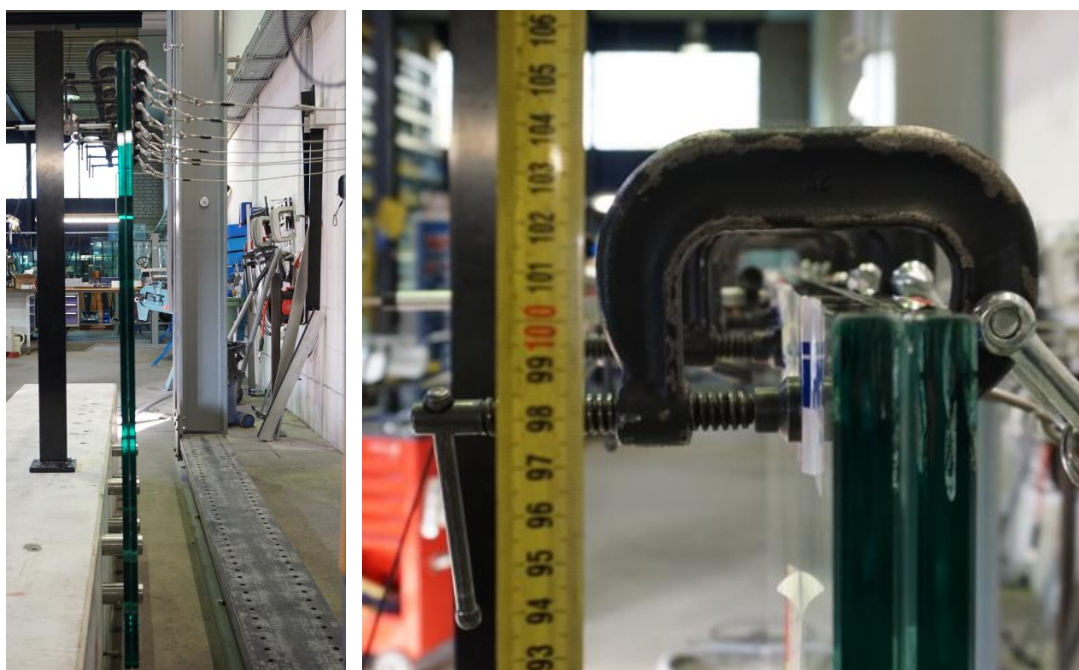
Image 9 Montage d'un essai statique sur garde-corps avec vérin et capteur de force : vue de côté (à gauche) et vérification de la hauteur d'application des charges ponctuelles (à droite)
