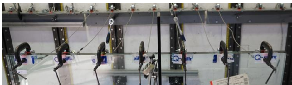
Image 10 Montage d'un essai statique sur garde-corps avec vérin et capteur de force : vue de face
