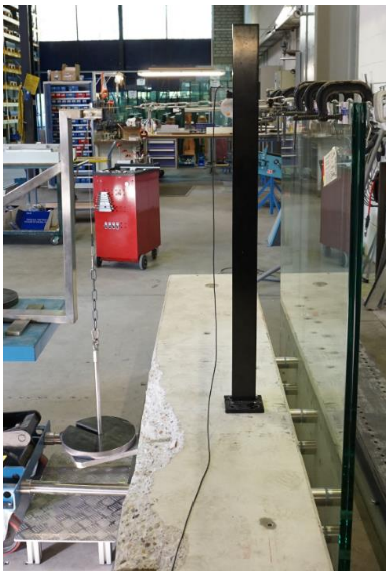
Image 11 Montage d'un essai statique sur garde-corps (Essai statique horizontal vers l'intérieur)
